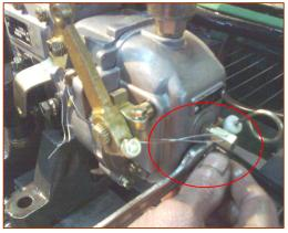
警告:在将调节螺套往里旋时,要缓慢旋转调节螺套,不能无限往里旋转, 否则可能导致功率不足或柴油机飞车。如出现功率不足或飞车现象,应将调节螺 套退出,重新调整。
